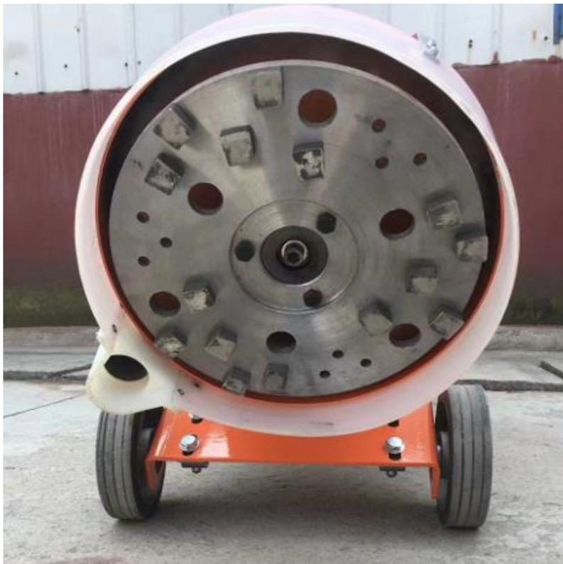
**Мозаично-шлифовальная машина с установленными фрезами (из набора фрез)**
